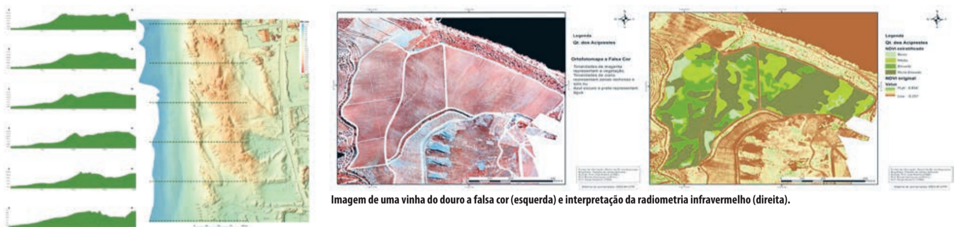
Modelo altimétrico da praia da Ramalha (Apúlia) e exemplos de perfis de praia e duna obtidos a partir do modelo.
